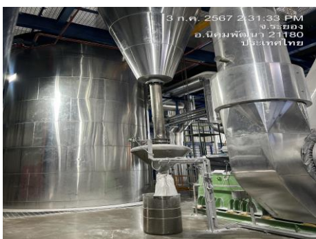
ภาพที่ 2.2-3 ระบบ Cyclone บริเวณหน่วยผลิต เม็ดพลาสติกพีดี (SSP)
